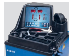
Панель управления с лотками для грузиков и инструмента
