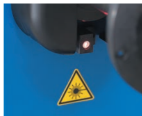
Лазерный указатель места установки грузов
