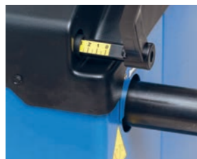
Линейка для измерения дистанции диска
