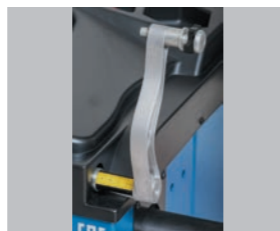
Линейка для измерения дистанции диска
