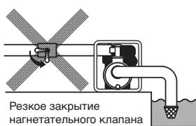
При наполнении водой всасывающий шланг оказывает воздействие на насос, в результате чего насос может упасть в котлован. Не допускайте падения в котлован всасывающего шланга, заполненного водой. Сильный рывок может привести к повреждению шланга и корпуса насоса.
