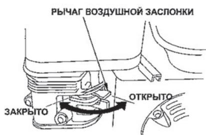
**Рычаг ВОЗДУШНОЙ ЗАСЛОНКИ** служит для открытия и закрытия воздушной заслонки в карбюраторе. В положении «ЗАКРЫТО» топливно-воздушная смесь обогащается. Это позволяет запустить «холодный» двигатель. Положение «ОТКРЫТО» используется для работы двигателя после запуска, а также для повторного запуска «горячего» двигателя.
