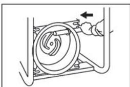
В) После использования помпы перед ее хранением слейте воду из помпы через сливное отверстие в нижней части корпуса.
