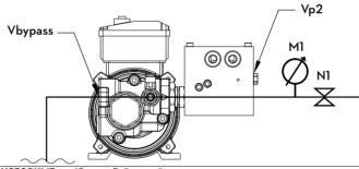
УСЛОВНЫЕ ОБОЗНАЧЕ-Vbypass: Байпасный клапан; Vp2: Клапан отключения Манометр ГОРИТ: наличие сетевого напряжения; ГОРИТ: насос перекачивает жидкость; МИГАЕТ: давление в линии нагнетания превысило значение
