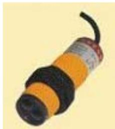
Для удобства использования и улучшения работы ограничения подъема по высоте автомобиля двухстоечных подъемников напольного типа, компания KraftWell разработала и внедрила в конструкцию фотоэлектрический датчик для замены обычного механического концевого выключателя. Ниже приведена спецификация.
