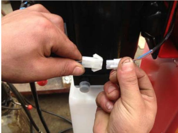
После этих двух шагов подъемник может нормально работать. Фотоэлектрический датчик остановит подъём автомобиля на расстоянии 15 см.
