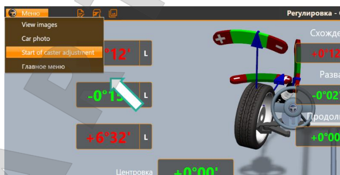
Рисунок 3.32 – Запуск режима регулировки продольного наклона шкворня
