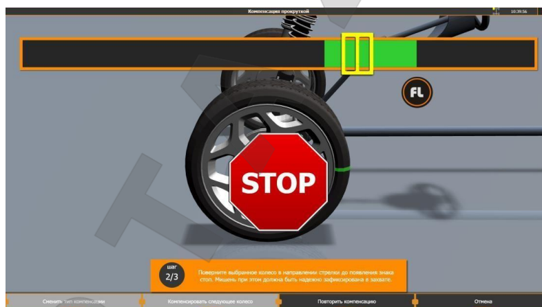
Рисунок 3.26 – Поворот колеса в нужное положение
