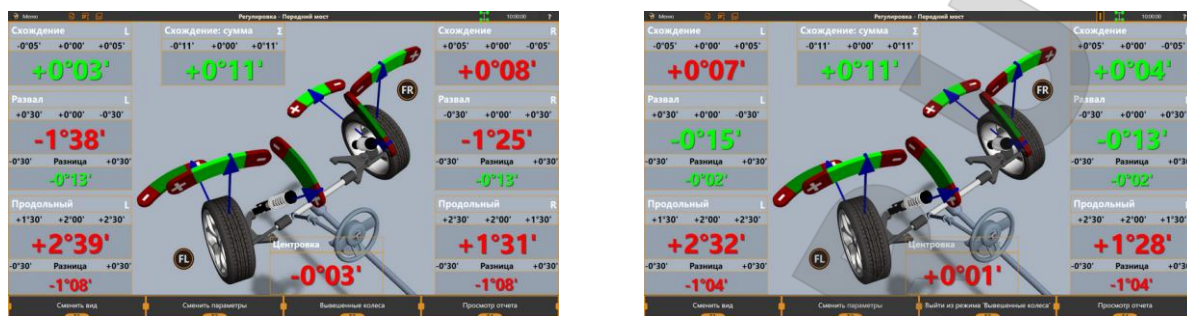
Рисунок 3.54 – Значения углов установки для вывешенного колеса
