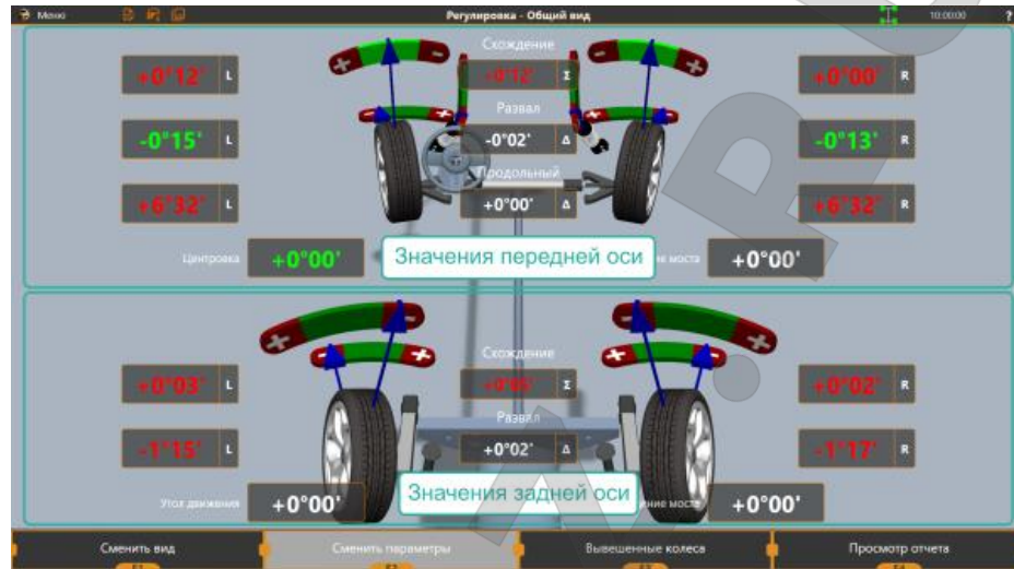
Рисунок 3.49 – Пример экрана в режиме регулировки
