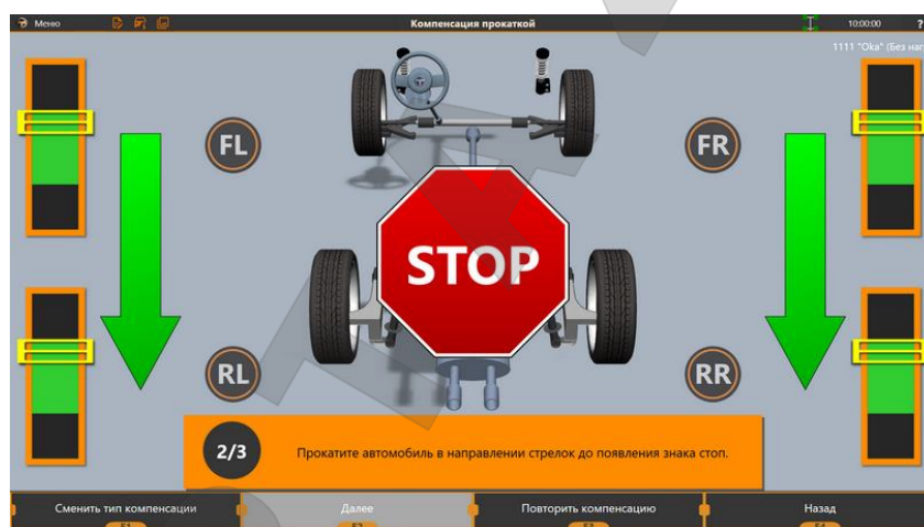
Рисунок 3.31 – При появлении знака Stop прокатку нужно прекратить
