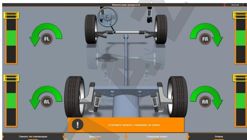
Рисунок 3.24 – Установка мишеней для компенсации прокруткой
