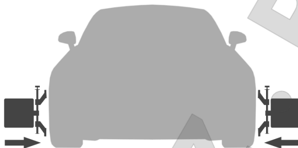
Рисунок 3.18 – Крепление колёсных адаптеров с мишенями
