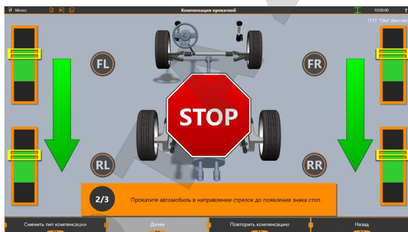
Рисунок 3.27 – При появлении знака Stop прокатку нужно прекратить
