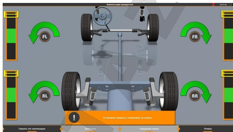
Рисунок 3.20 – Установка мишеней для компенсации прокруткой
