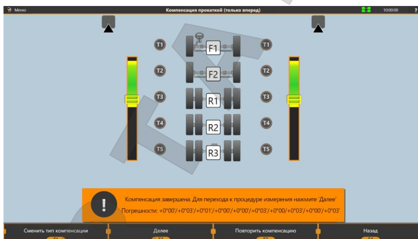
Рисунок 3.37 – Результат компенсации прокаткой только вперёд
