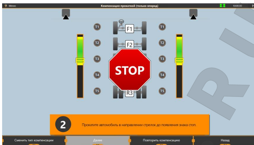
Рисунок 3.36 – Прокатка автомобиля вперёд
