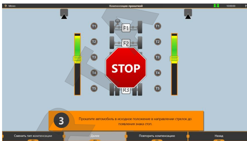
Рисунок 3.31 – Прокатка автомобиля вперёд
