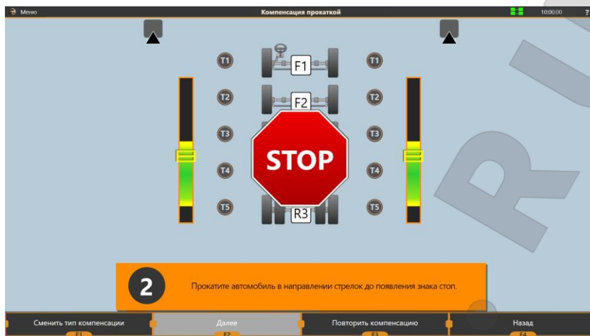
Рисунок 3.30 – Прокатка автомобиля назад
