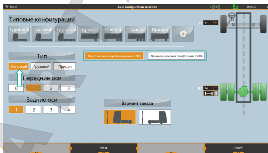
Рисунок 3.9 – Измерение автомобилей с короткой колёсной базой
