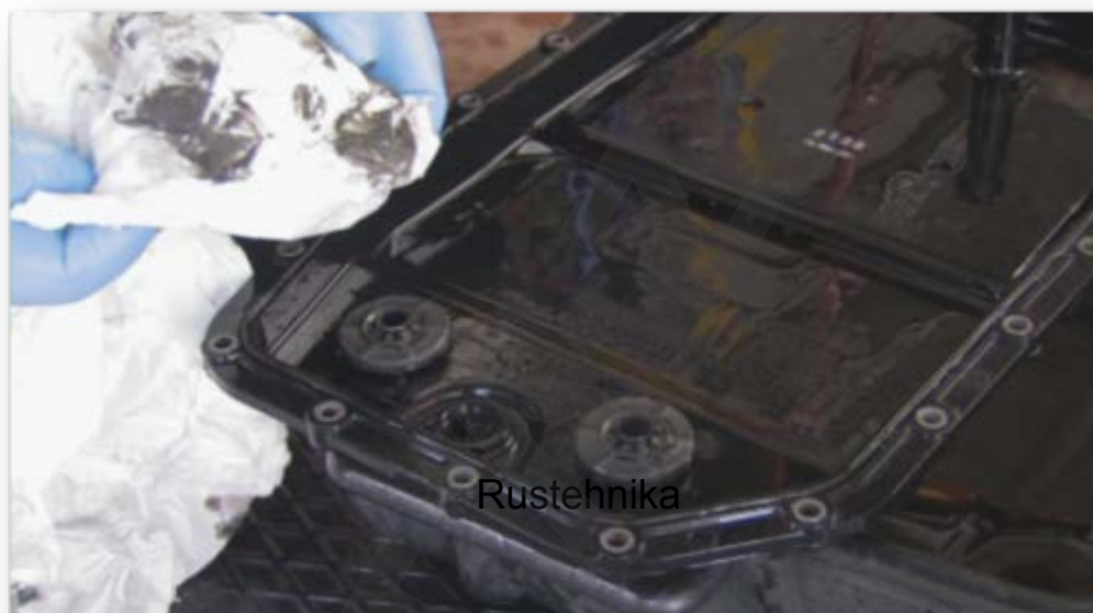
Figura 3 - Esempio di coppa dopo 37.000 Km
