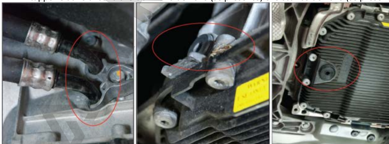
Figura 15 - Tubi mandata e ritorno, Spia livello, Tappo scarico
