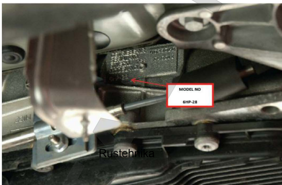
Рис. 16. Пример идентификационной таблички трансмиссии.
