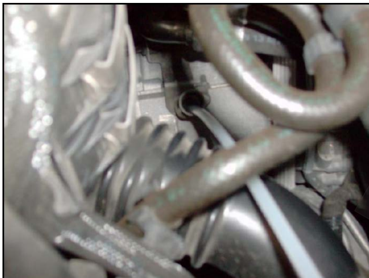
Рис. 27. Соедините трубку для замены масла с герметичной трансмиссией.
