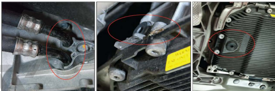
Рис. 17. Загрузочный и дренажный патрубки, индикаторный уровень, дренажная пробка.
