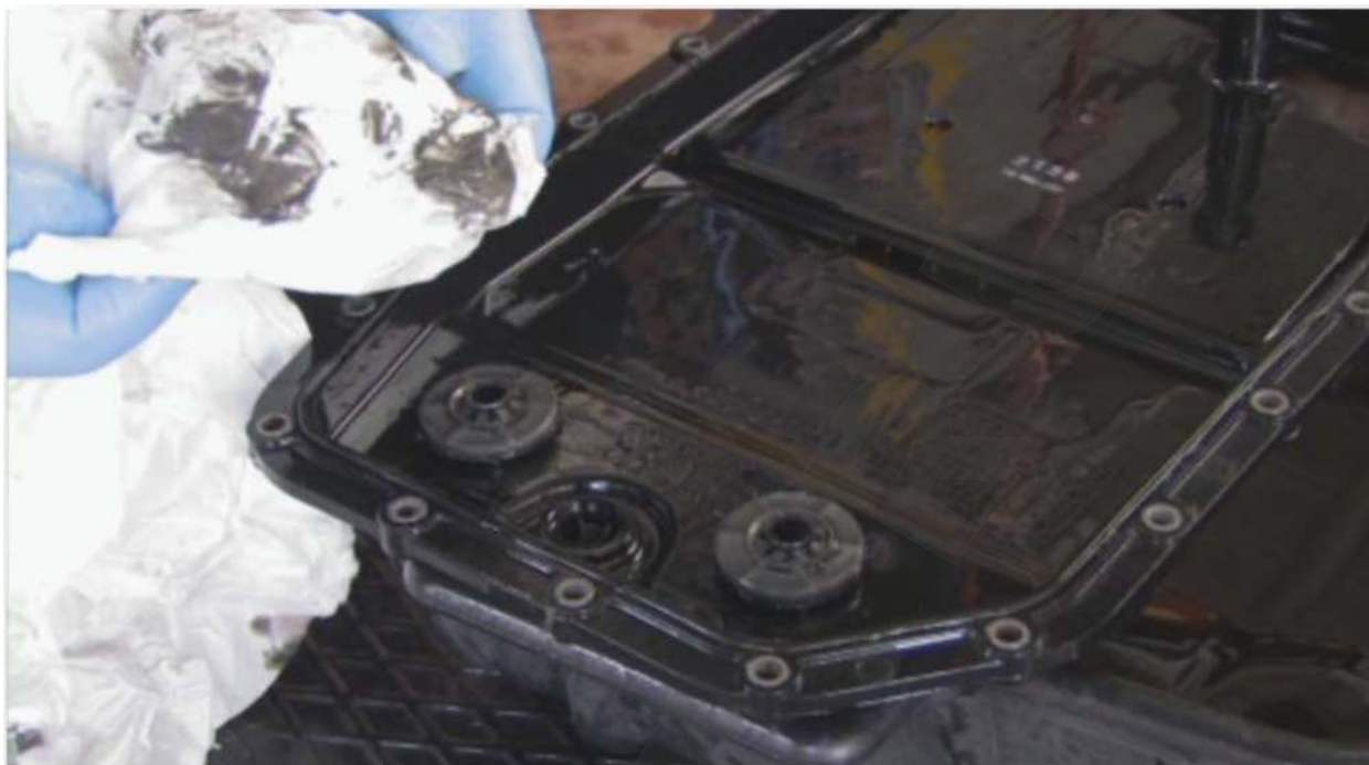
Рис. 3. Пример загрязнения трансмиссии автомобиля, чей пробег составлял 37.000 км.
