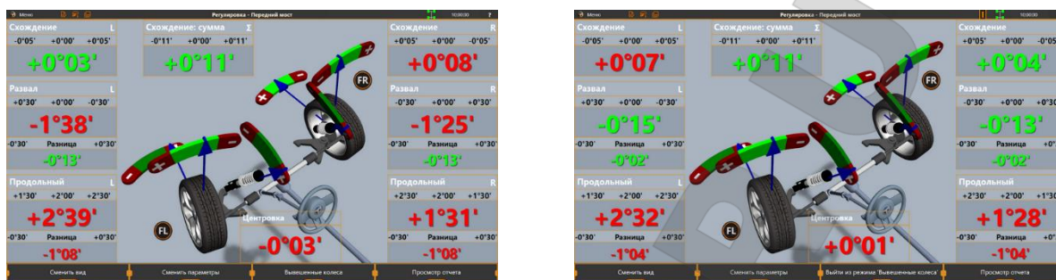
Рисунок 3.55 – Значения углов установки для вывешенного колеса
