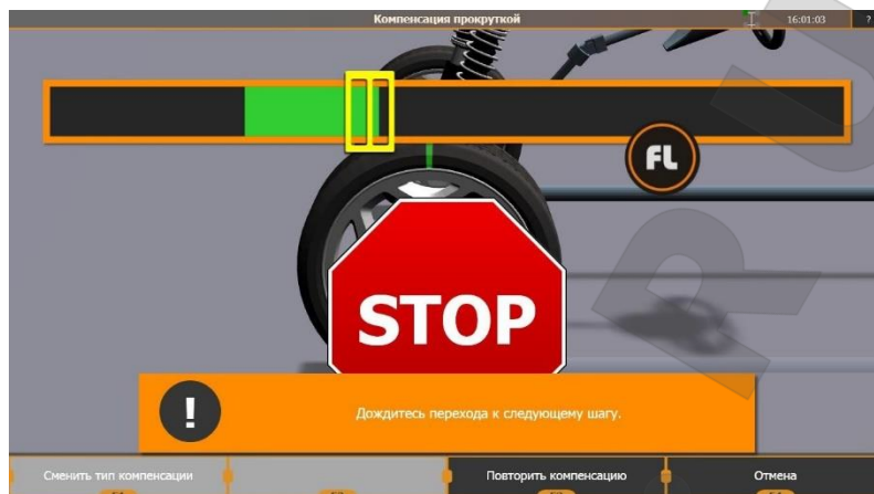
Рисунок 3.26 – Вычисление изначального положения мишени для компенсации
