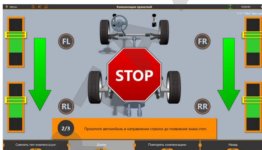
Рисунок 3.32 – При появлении знака Stop прокатку нужно прекратить
