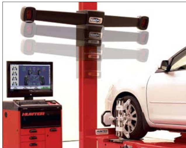
HS401LZ2E имеет полнодиапазонную подвижную балку с электроприводом, обеспечивая дополнительные рабочие высоты подъемника, а также позволяет работать с автомобилем на полностью опущенном подъемнике.*
