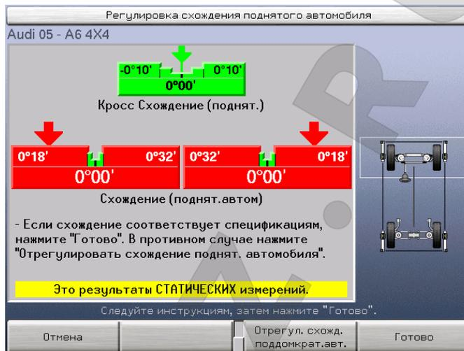
Нажатием клавиши «Отрегулировать схождение поднятого автомобиля» осуществляется переход на активный (регулировочный) экран.
