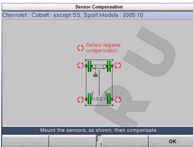
ПРИМЕЧАНИЕ: Экран компенсации различается в зависимости от типа датчиков.
