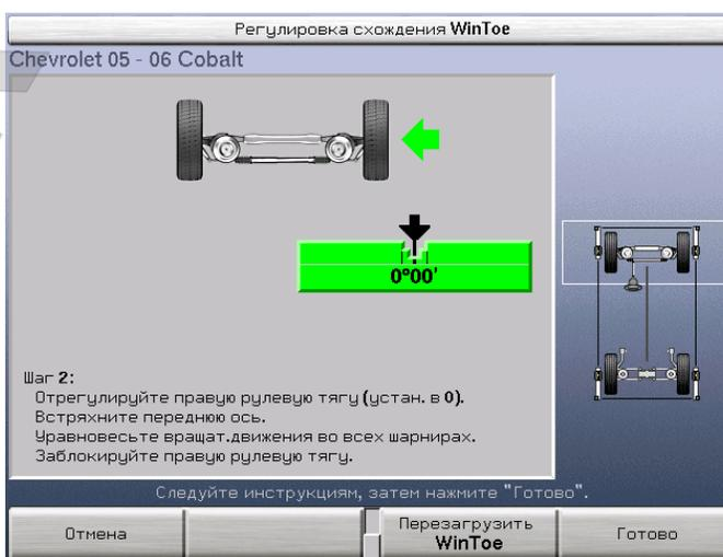
Следуя инструкциям на экране, отрегулируйте правую поперечную рулевую тягу так, чтобы индикатор на диаграмме оказался в центральном положении.
