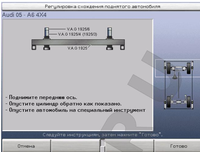
Нажмите Готово и экран покажет дополнительный спец. инструмент и инструкции. Нажмите Готово для выведения экрана «Регулировка схождения поднятого автомобиля». Это не активный экран, о чем известит Вас желтое предупреждение.
