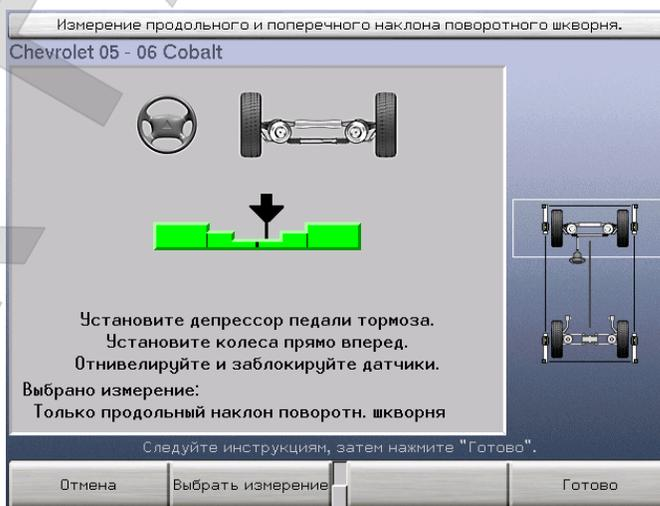
Установите депрессор педали тормоза. Вращая рулевое колесо, поставьте колеса прямо – так, чтобы диаграмма показывала «центровое» положение. Затем отнивелируйте и зафиксируйте датчики. Нажмите клавишу «Готово» – это позволит системе сделать «снимок» текущих измерений.
