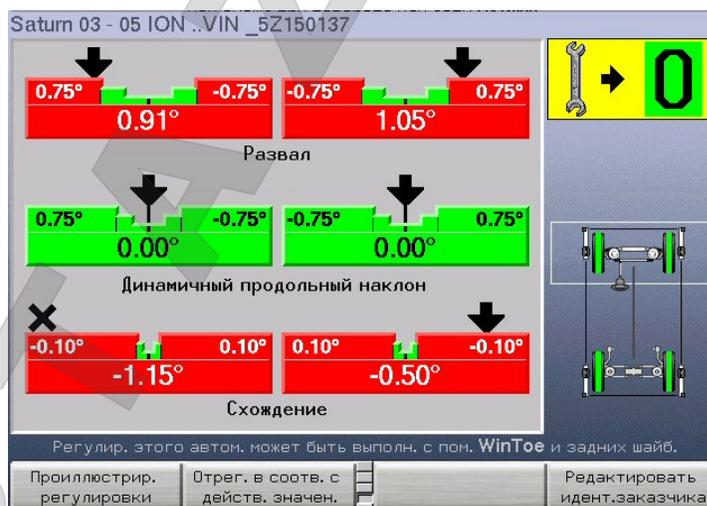
Переключение между форматами «регулировка к нулю» и «регулировка к действительному значению» осуществляется нажатием клавиш «Регулировать к нулю» и «Регулировать к действительному значению».
