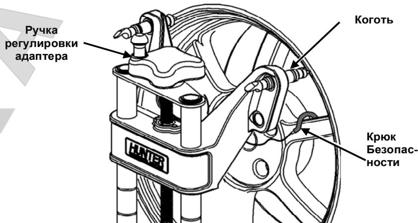
Проворачивайте регулировочную рукоятку адаптера для его расширения до габаритов обода
