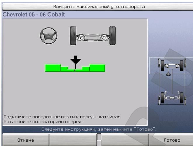
Датчики серии DSP500 вместе в электронными поворотными кругами используются для измерения максимальных углов поворота.
