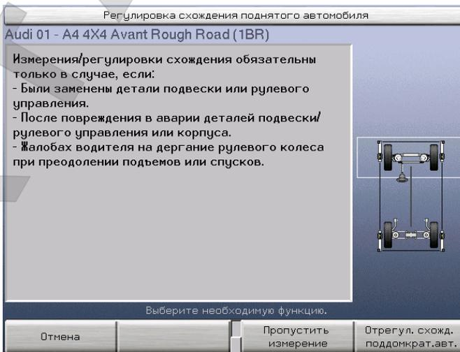
Выбор «Регулировать схождение поднятого автомобиля» выведет следующие экраны данной процедуры с показом спец.инструмента VAG и инструкций. В зависимости от спецификаций автомобиля спец. инструмент различается. Следуйте инструкциям на экране.
