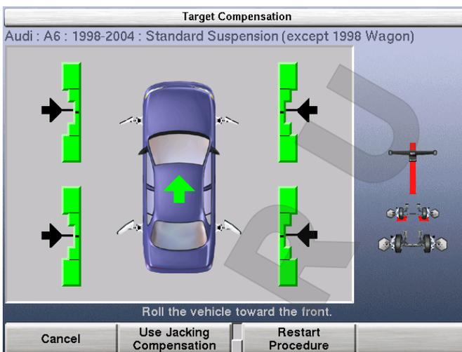
После окончания компенсации всех четырех мишеней поставьте автомобиль на стояночный тормоз и переведите рычаг переключения передач в положение "парковка". На автомобилях со стандартной трансмиссией рычаг переключения передач следует установить на нейтраль.
