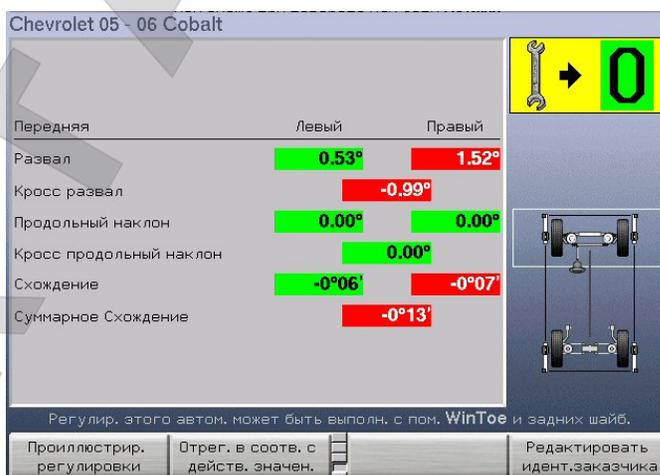
**ВНИМАНИЕ:** Не путайте форматы «регулировка к нулю» и «регулировка к действительному значению». Во избежание путаницы данные в этих форматах отображаются на экране по-разному. Обратите особое внимание на большую пиктограмму «регулировки к нулю», которая появляется в верхнем правом углу при использовании этого формата.
