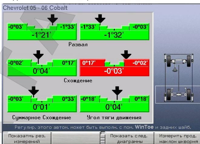
Когда регулировочные значения задних колес будут приведены в норму, переходите к регулировке развала и продольного наклона поворотного шкворня передних колес. Нажимайте клавишу «Показать след. диаграммы» до тех пор, пока нужные диаграммы не появятся на экране.
