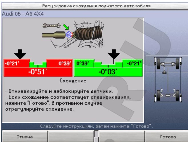
Отрегулируйте схождение к спецификации и нажмите «Готово». Экран покажет дополнительный спец. инструмент и инструкции.
