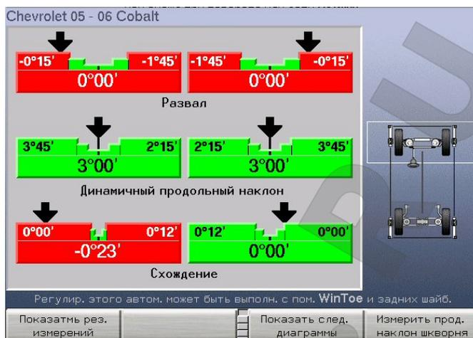
В начале регулировки кастера поставьте колеса прямо вперед и зафиксируйте рулевое колесо. После этого датчики начнут отслеживать изменения кастера по мере того, как Вы будете осуществлять регулировку. Следя за диаграммами, отрегулируйте по ним развал и кастер передних колес.
