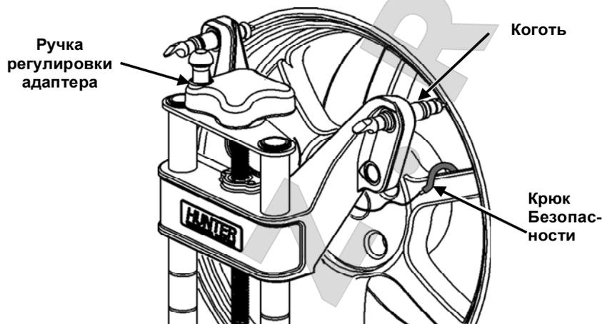
Проворачивайте регулировочную рукоятку адаптера для его расширения до габаритов обода.
