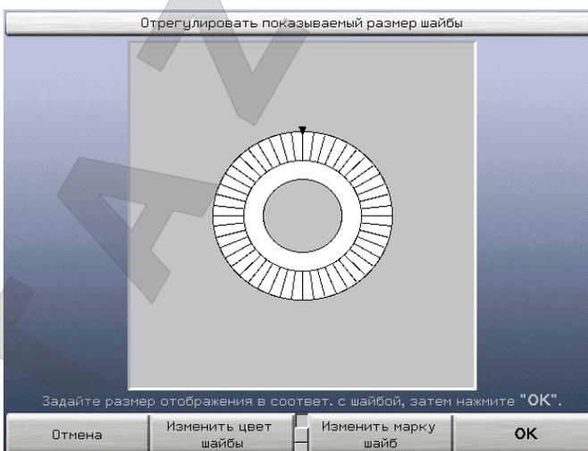
Нажатием клавиш «Изменить цвет шайбы» и/или «Изменить марку шайбы» обеспечьте соответствие изображения на экране данной шайбе.
