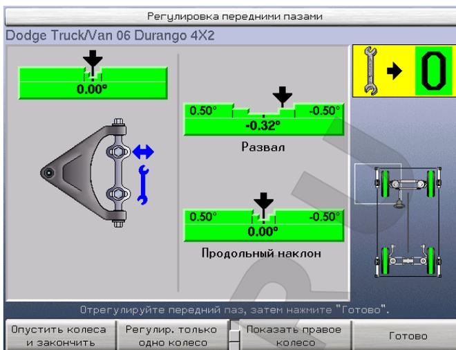
В случае необходимости продолжите регулировку и доведите ее до максимальной точности, переключаясь между фронтальным и тыловым пазом нажатием клавиши «Готово». Каждый раз при нажатии клавиши «Готово» алайнер, прежде чем переключиться на другой паз и показать его диаграмму, повторно анализирует необходимые изменения.
