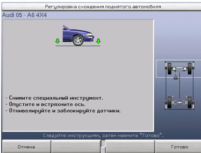
Нажмите «Готово» для возврата на экран «Измерения и регулировки автомобиля».
