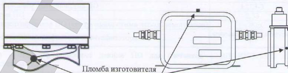
Рисунок 18 – Схема пломбировки ВП ЛУЧ-03 и ЛУЧ-04
