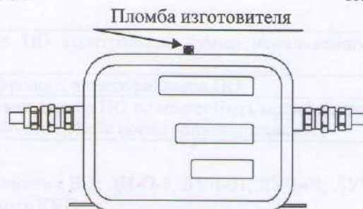
Рисунок 20 – Схема пломбировки КУП
