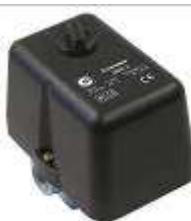
**Реле давления Condor MDR** предназначено для автоматизации работы компрессора, включая его при понижении давления в системе ниже установленного предела и отключая при достижении верхнего установленного предела давления. Следствием использования такого реле является увеличение срока эксплуатации компрессора, а также снижение потребления электроэнергии.
