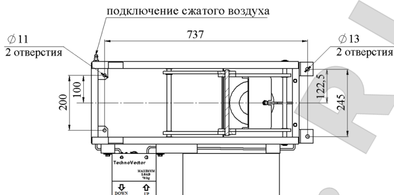
Рисунок 10 – Схема крепления подъёмника
