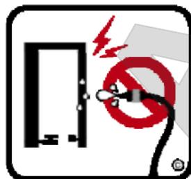
НЕ ДОПУСКАЙТЕ ПРЯМОГО ПОПАДАНИЯ ВОДЫ ИЗ ШЛАНГА НА ПОДЪЕМНИК.
