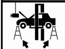
При установке, снятии или передвижении тяжелого оборудования всегда пользуйтесь безопасными стойками (стремлянками).
