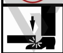
Следите, чтобы ноги оставались на безопасном расстоянии от подъемника во время опускания автомобиля
