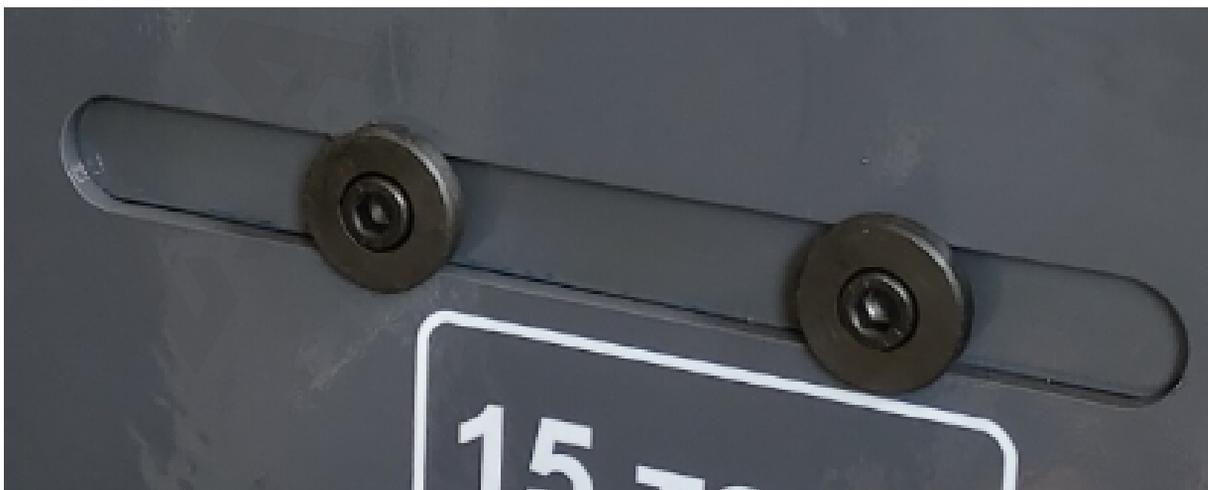
Отрегулируйте ширину подъемника в соответствии с размером ямы.
