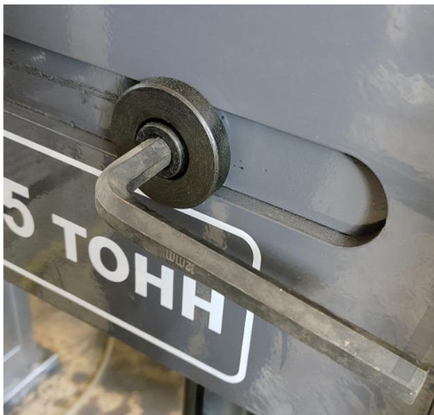
затем шестигранником затяните винты (спереди и сзади) после правильной установки.
