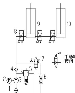
1. Фильтр 2. Эл-двигатель 3. Шестеренный насос 4. Обратный клапан 5. Клапан редукционный 6. Клапан регулировки скорости опускания кареток 7. Электронный разгрузочный клапан (с рукояткой опускания кареток) 8. Дроссель или клапан перегрузки 9. Основной гидроцилиндр 10. Дополнительный гидроцилиндр
