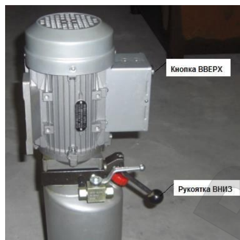
Рис. 27 Стандартное оснащение (гидравлическая станция без пульта управления)
