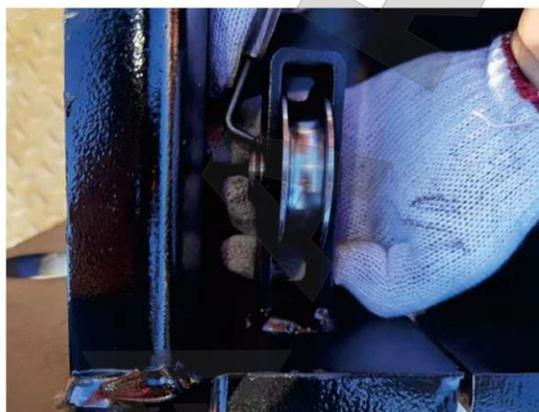
Шесть шкивов подъемника (по три на каждой стойке) одинаковы и монтируются вышеописанным способом. Демонтаж выполняется в обратном порядке. У подъемников с нижней поперечной балкой каждая стойка имеет два нижних и один верхний шкив. У подъемников с верхней поперечной балкой каждая стойка имеет два верхних и один нижний шкив.
