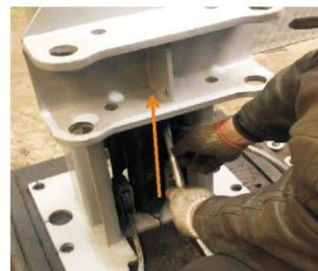
Рис. 7-5. Закрепить трос в отверстии и затянуть гайки с двух сторон.
