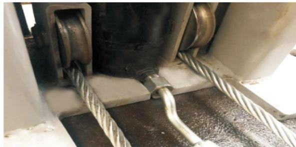
Рис. 9. Закрепить трос в отверстии и затянуть гайки с двух сторон.
