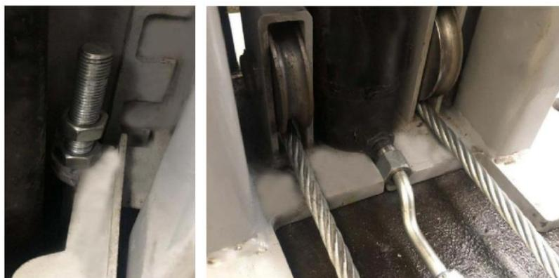
Рис. 11. Подключить короткую трубу к насосу и к штуцеру в нижней части подъемника.
