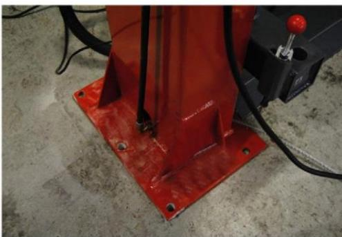
Рис. 12. Установить кожух трубы и закрепить его, вставив в пазы опорной плиты.
