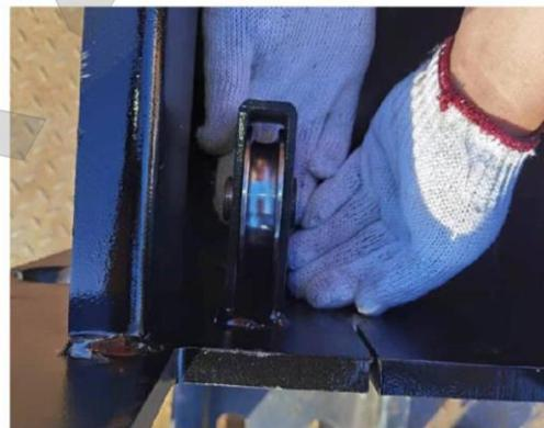
Рис. 19. Вставить в канавку ступицы стопорное кольцо для фиксации. На этом монтаж завершен.
