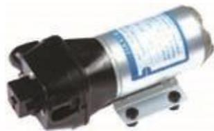
Мембранные электрические автоматические насосы серии CDP-35 на 12 и 24 вольта предназначены для перекачивания пресной и морской воды, молока, соков, вин и других нейтральных жидкостей, схожих по свойствам с водой.
