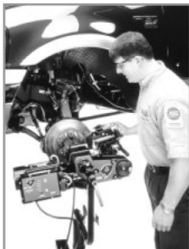
Станок PFM 9.0 для расточки тормозных барабанов непосредственно на автомобиле
