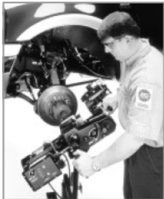
Шаг 2 Решения 4/9.0: техник устанавливает станок на адаптере.
