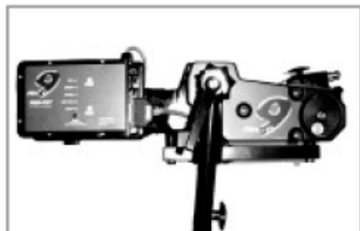
Станок расположен рабочей стороной вверх. При таком положении упрощается регулировка режущей головки.
