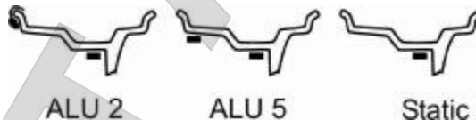
Рисунок 5.5 – Схемы установки грузов, не требующие ввода ширины
