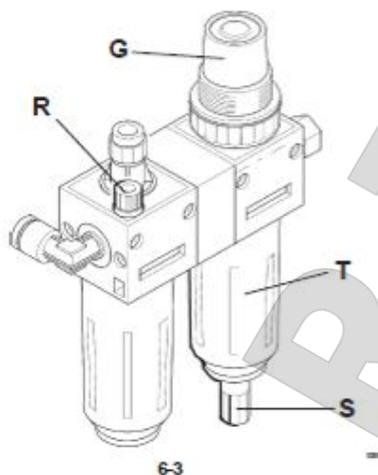
Проверять рычаги отжимного устройства и заменять при износе. Ежедневно выпускать конденсат из воздушного фильтра-влагоотделителя, для чего вынуть пробку (S, рис. 6.3).
