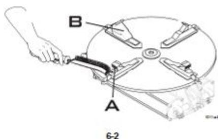
Чистить металлической щеткой зубья (А) зажимных кулачков; контролировать износ пластиковых накладок (В), и при необходимости выполнять их замену (рис. 6.2).
