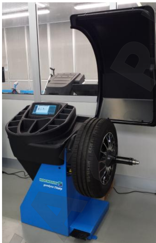
Рисунок 1 - Общий вид стендов балансировочных под товарным знаком «HOFMANN» серии GEODYNA моделей 7340 S, 7340 L, 7340 P
