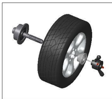
Вал станка - Колесо - Конус (вершиной внутрь) - Быстросъемная гайка
