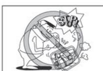
При заправки и дозаправки топливом удостоверьтесь, что двигатель выключен.
