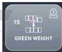
Рисунок 7.2 – Клавиша-индикатор GreenWeight: колесо может быть отбалансировано одним грузом 15 г
