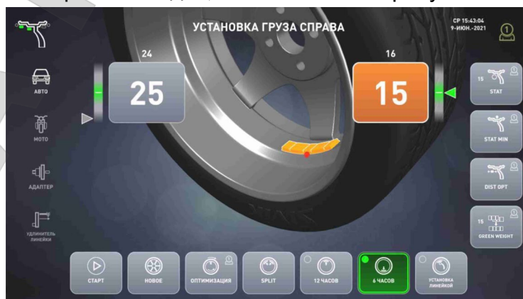
Рисунок 5.8 – Установка в «6 часов» справа
