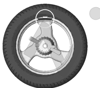
Рисунок 6.5 – Груз установлен в «12 часов»
