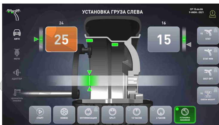
в – установка груза линейкой
