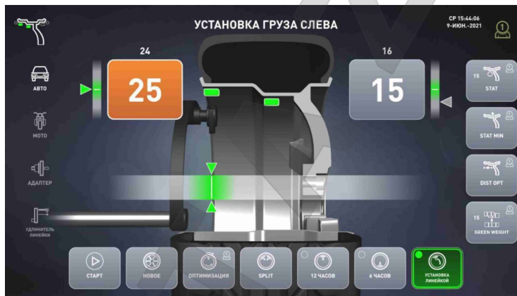
Рисунок 5.10 – Экран при установке груза линейкой
