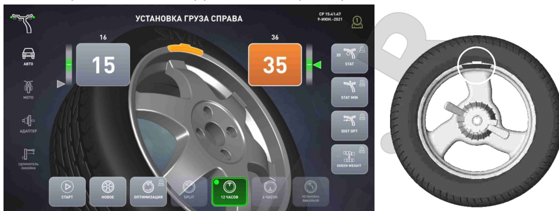
а – экран при установке груза со скобой
