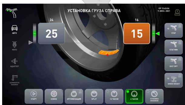
а – установить ленточный груз 15 г справа
