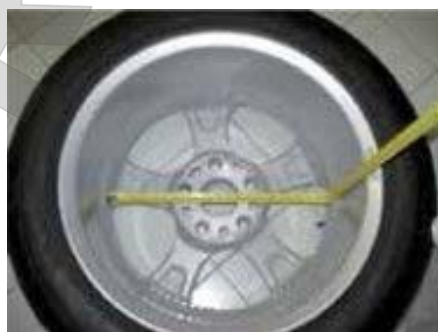
Рис. 3.3.1 Пример ручного измерения внешнего диаметра (da2) колеса в программах ALS1/ALS2
