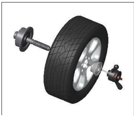
Главный вал - колесо - подходящий конус (маленькая головка по направлению внутрь) - гайка с быстрозажимной ручкой
