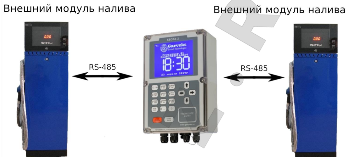
Рисунок 5: Конфигурация с внешними модулями налива, два поста
