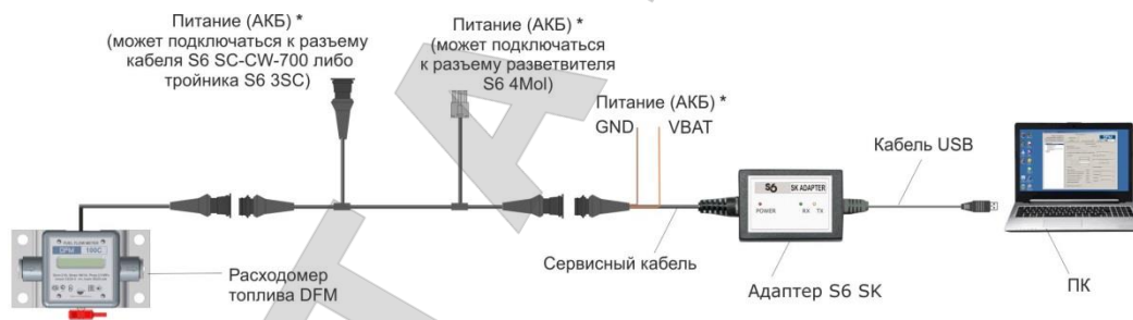
а) подключение DFM с помощью S6 SK
