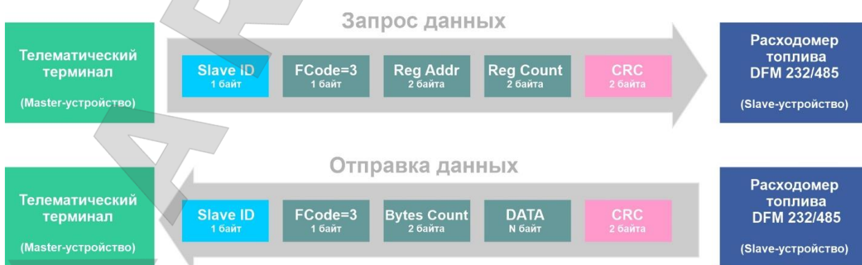
Рисунок Г.1 — Схема обмена данными по протоколу Modbus RTU между расходомером DFM 232/485 и Телематическим терминалом
