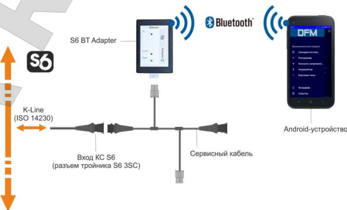
б) подключение DFM CAN с помощью S6 BT Adapter по Технологии S6
