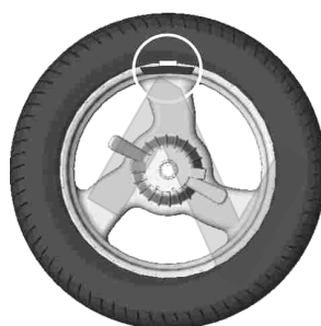
Рисунок 6.5 – Груз установлен в «12 часов»
