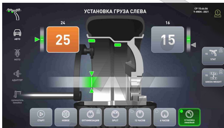
в – установка груза линейкой
