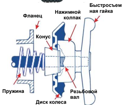
Центрирование с помощью заднего конуса
